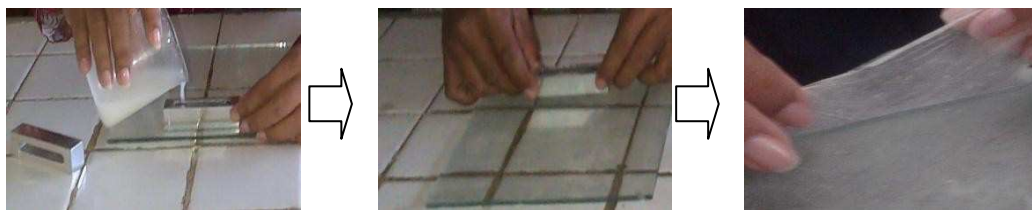
Gambar 1. Proses pembuatan biofilm dengan metode solution casting
