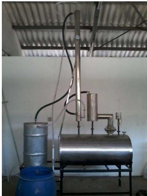
Gambar 2. Mesin Destilator yang telah dimodifikasi
